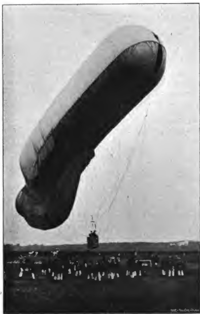
Der Aufstieg des Fessel-Drachensballons beginnt, nachdem das Haltkabel am Windewagen befestigt ist.
